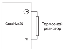
Рис. 12-3. Схема подключения тормозного резистора
